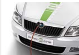
Jedinečný detail modelů Green E Line: elektrická přípojka pod firemním emblémem s okřídleným šípem.
